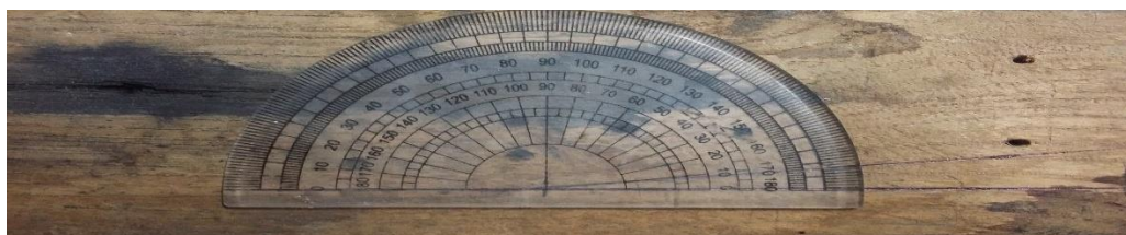
Figura 3.12: Inclinação elevada do Fio da tábua G.
