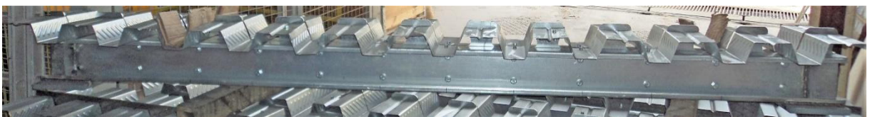
Figura 5.28 – Provette 2 com conector de chapa lisa do tipo Indentado, para ensaio.
