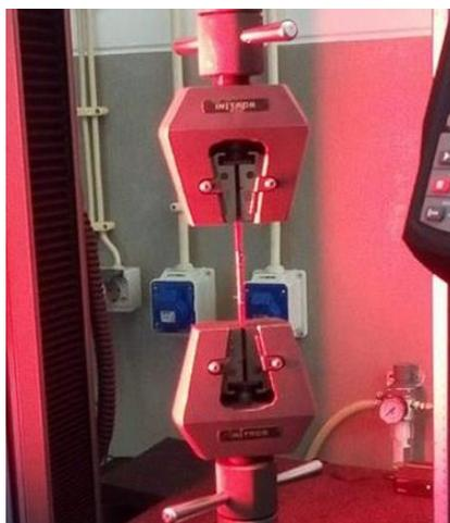
**Figura 26.** Equipamento utilizado no ensaio de tração
