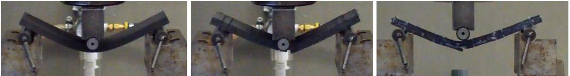
**Figura 44.** Provetes de flexão aquando o ensaio mecânico
