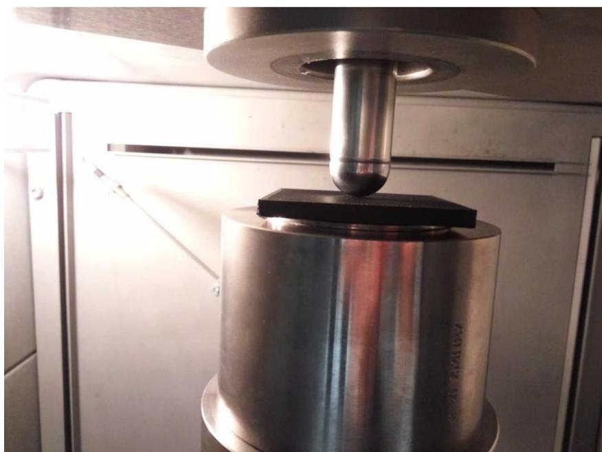
**Figura 28.** Equipamento utilizado no ensaio de impacto
