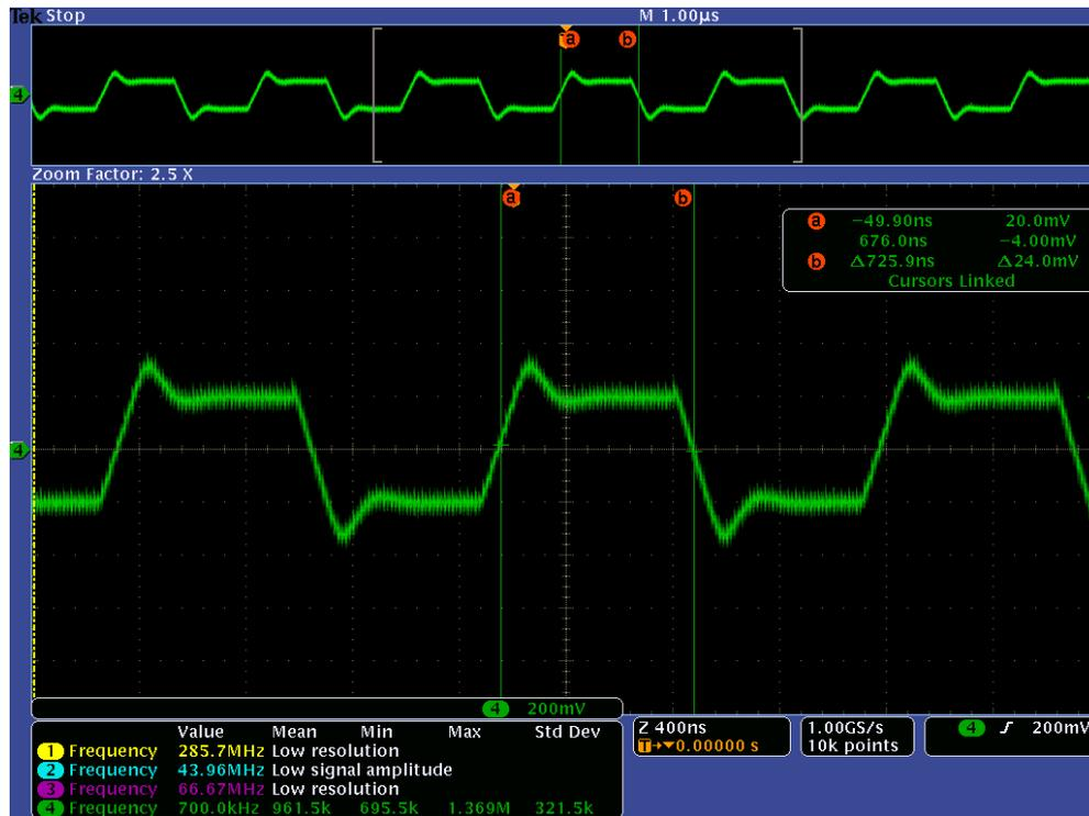
Figura 6-4 - Frequência de Amostragem DAC
