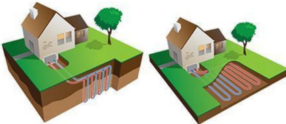
Figura 11- Esquema enterrado verticalmente (esquerda) e horizontalmente (direita), (Tavares, J. 2011)
