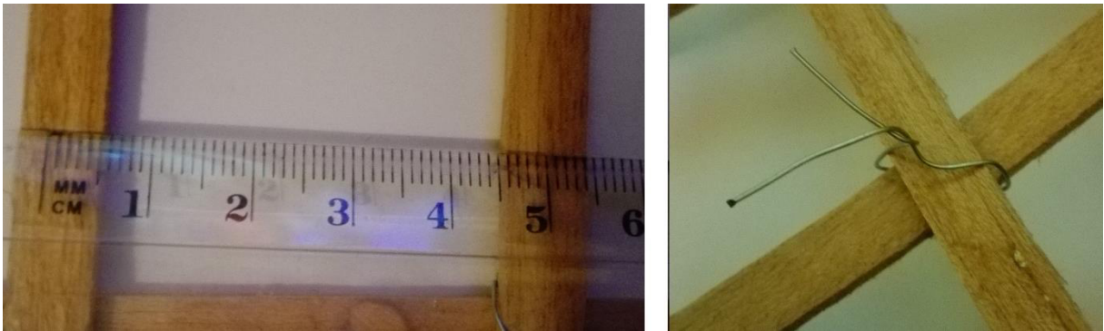
Figura 52 - Dimensão dos quadrados interiores e ligação que permite deslocamento
