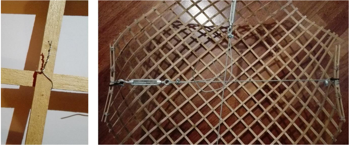
Figura 55 - Ligação final e sistema de cabos
