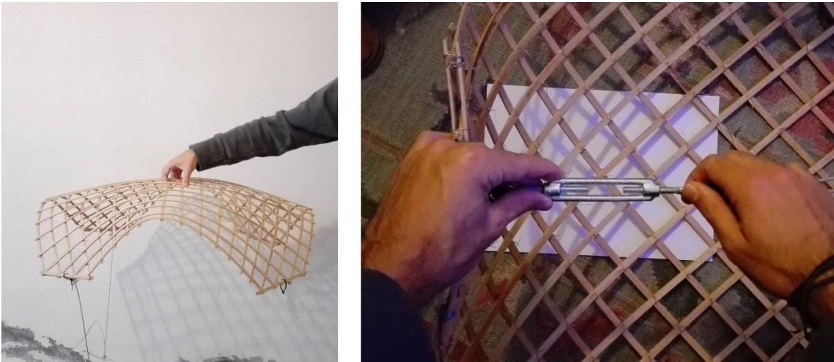
Figura 54 - Elevação da malha e aperto dos esticadores
