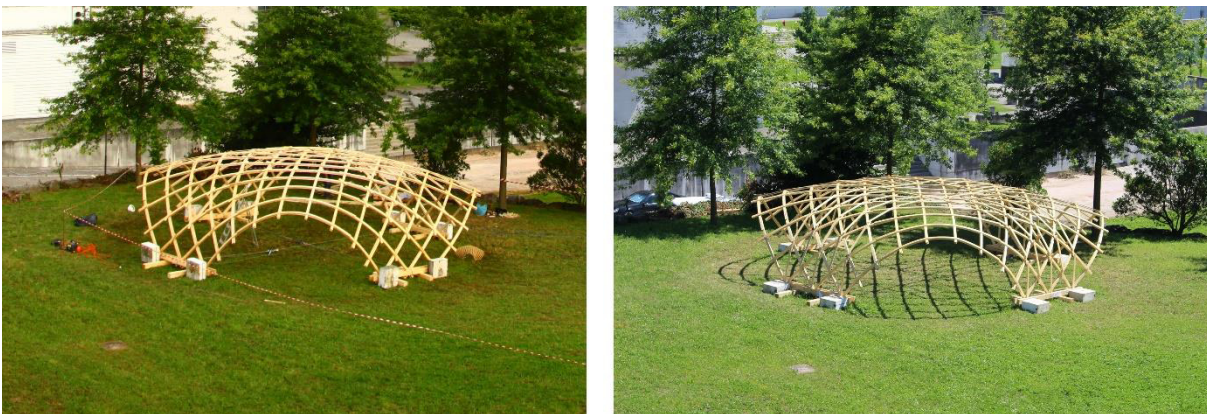
Figura 134 - Deformação da estrutura após 8 dias
