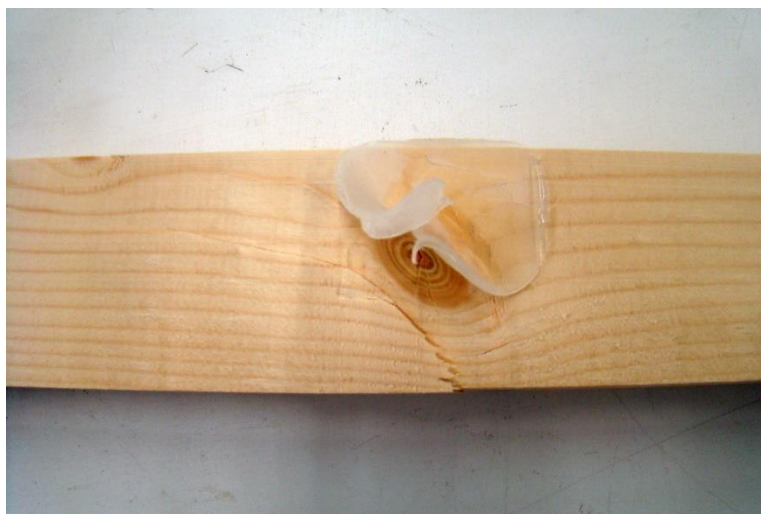
Figura 43 - Presença de nó na zona de rotura no ensaio 8-550
