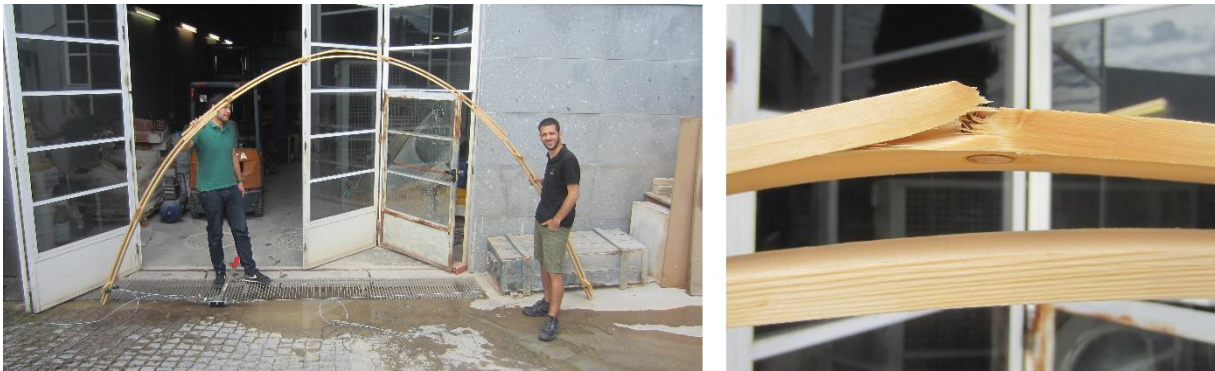
Figura 110 - Rotura do elemento do layer superior
