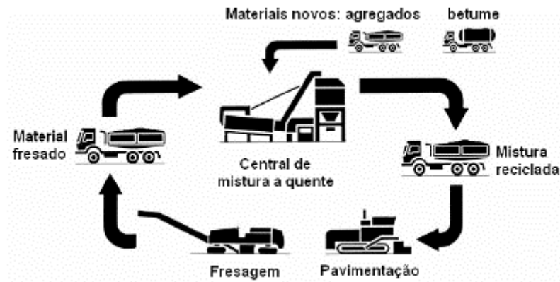
Figura 18 - Processo de reciclagem em central a quente com betume (Baptista, 2006)
