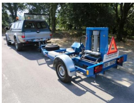
Figura 24 - Defletómetro de Impacto da Universidade do Minho, DYNATEST 8000 (Magalhães, 2015)
