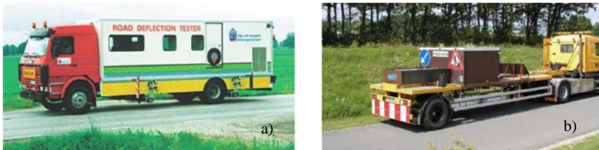
Figura 7 - Defletógrafos de Alta velocidade; a) Road Deflection Tester (RDT) - Suécia; b) High Speed Deflectograph (HSD) – Dinamarca
