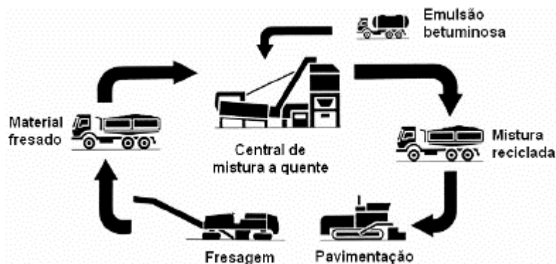
Figura 19 - Processo de reciclagem em central semi-quente (Baptista, 2006)
