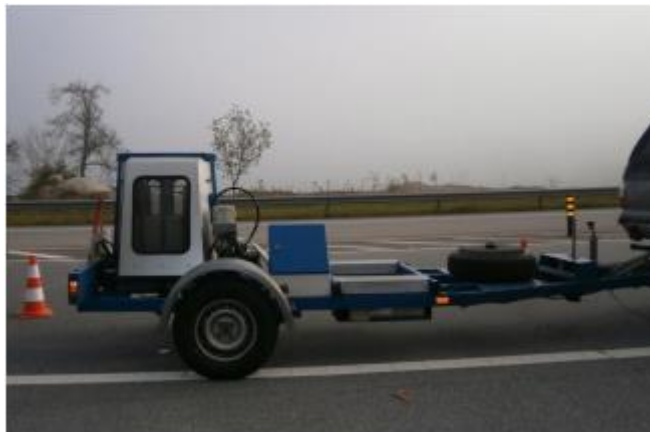
Figura 6 - Exemplo de defletómetro de Impacto (FWD) (Alves, 2007))
