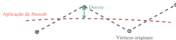
Figura 4.14: Esquema representativo da ferramenta Smooth no Geomagic Design X®
