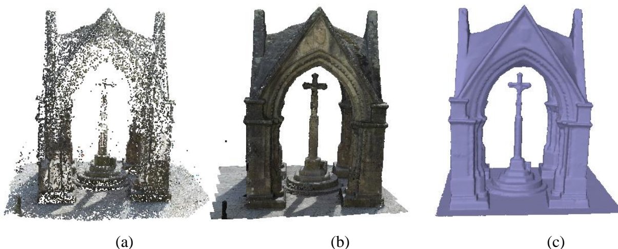
Figura 4.4: (a) Nuvem de pontos; (b) Nuvem de pontos densa; (c) Malha tridimensional;
