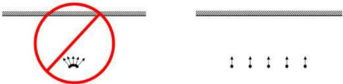
Figura 2.15: Requisitos de aquisição de dados no exterior (Agisoft LLC 2011)
