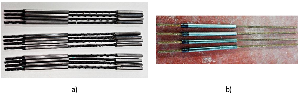
Figura 60 – Moldagem da zona de ancoragem, pull – out BCR (a), pull – out aço (b),
