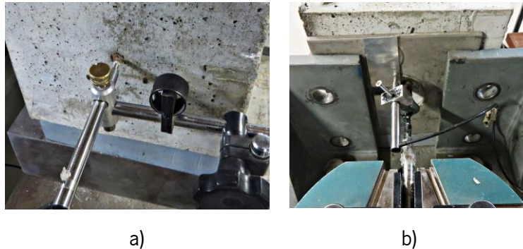
Figura 82 - Setup ensaio Pull - out
