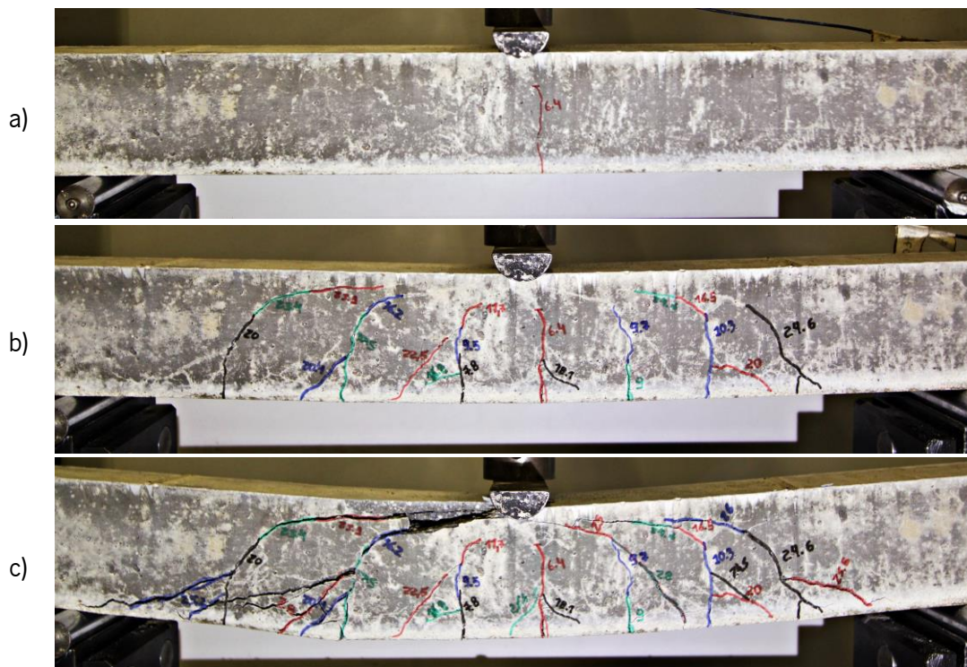
Figura 87 - Padrão fissuração laboratorial tipo em vigas de armadura BCR1 (a - primeira fissura; b - pré-esmagamento do betão; c - esmagamento do betão).
