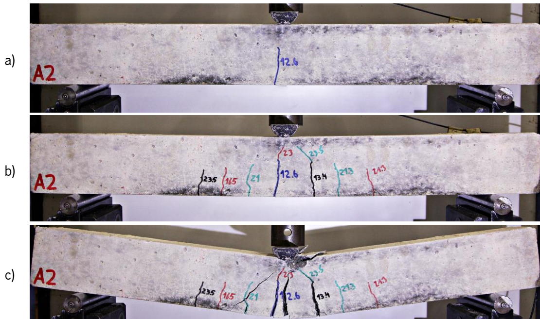
Figura 85 - Padrão fissuração laboratorial tipo em vigas de aço (a-fase plástica; b – fase elástica; c – esmagamento betão).
