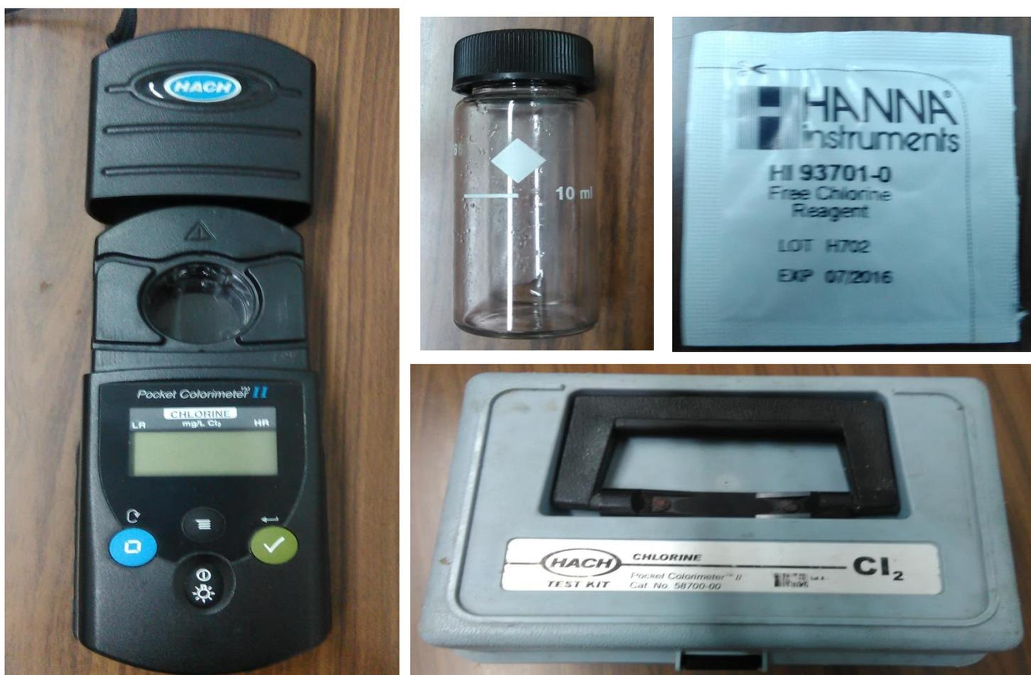
Figura 1: Fotografias dos instrumentos e reagente a utilizar para medição.
