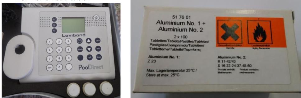
Figura 1: Fotografias do instrumento e reagente a utilizar para medição.
