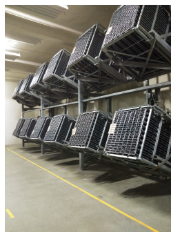
Figura 5. “ Riddling cage ” utilizada no método mecânico de remuage .
