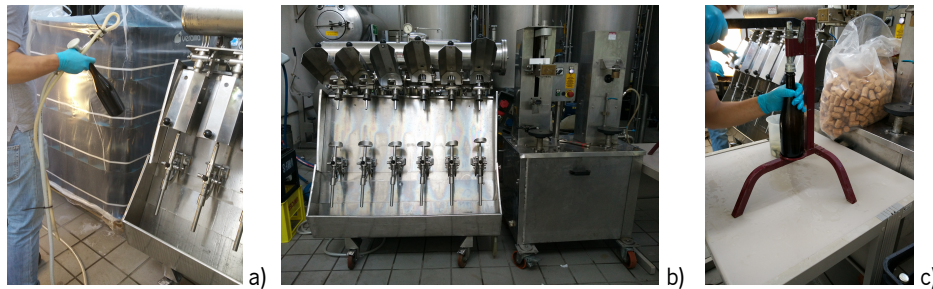
Figura 14. Procedimento do Bottle 10.1: a) Introdução de CO 2 , b) Máquina de enchimento e do lado direito o equipamento que coloca rolha e arame e c) Capsulador manual.
