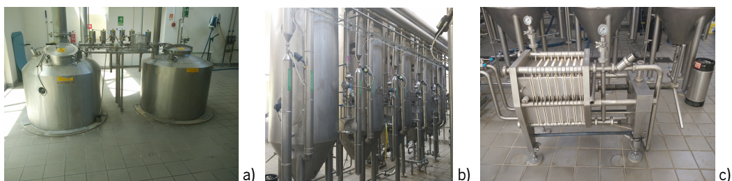
Figura 12. Procedimento do Bottle 10.1: a) Fabrico do mosto, b) Fermentação e maturação e c) Filtração.
