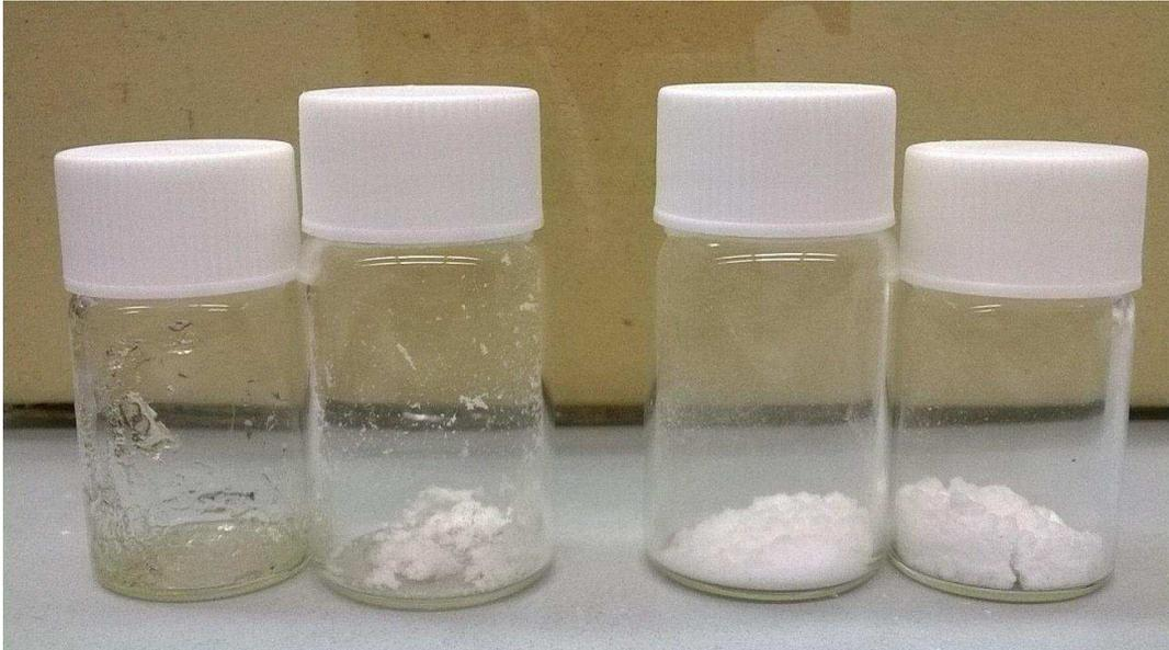
**Figura 21** – Nanopartículas sintetizadas nos ensaios 9, 10, 11 e 12 após liofilização (ensaios numerados da esquerda para a direita).
