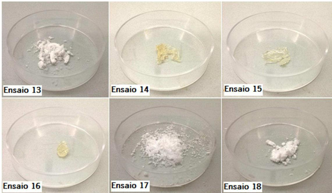
**Figura 22** – Nanopartículas sintetizadas nos ensaios 13, 14, 15, 16, 17 e 18 após liofilização.
