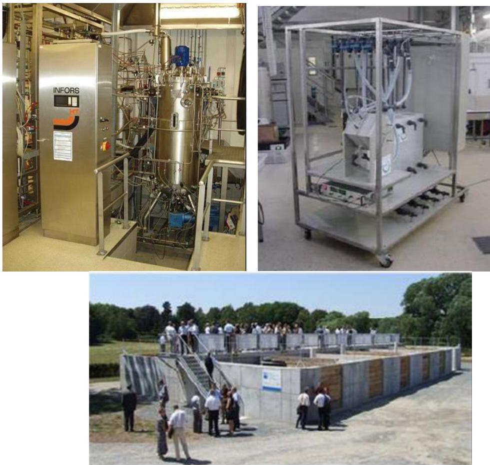
Figura 36. Biorreator de tanque agitado (0,4 m<sup>3</sup>) (superior esquerdo) e unidade de eletrodialíse (superior direito) situado no UFZ e o local de demonstração BDZ para o tratamento de águas residuais descentralizadas para ser utilizado no caso de estudo INCOVER 3.
