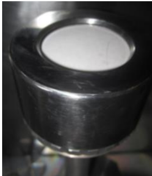
Figura 15 – Magnetron utilizado para realizar pulverização catódica no decorrer deste trabalho[16]
