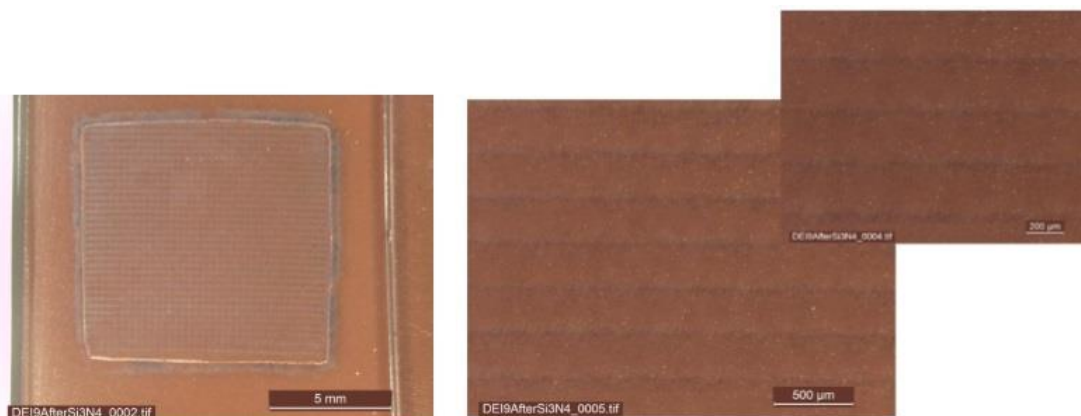
Figura 29 – Microscopia ótica da amostra DEI-9 após deposição de Si_3N_4
