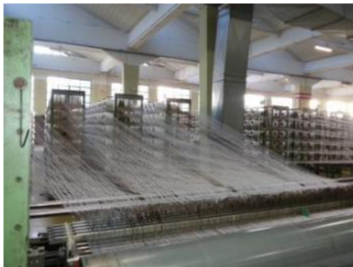
Figura 18 - Alimentação do tear
