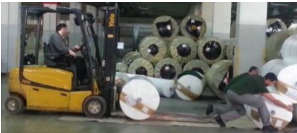
Figura 49 - Colocação dos rolos nas pás do empilhador
