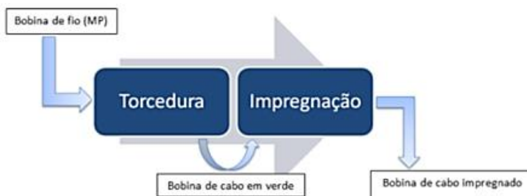
Figura 23 - Processo produtivo - cabo impregnado
