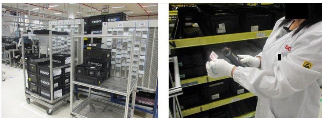
Figura 38 - Atrilados com caixas vazias e quadro com construção do lote de kanbans (à esquerda) e esvaziamento do e-kanban (à direita)
