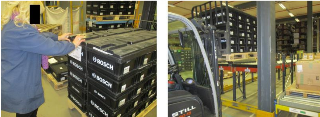
Figura 25 - Colocação de TO na paleta (à esquerda) e colocação da paleta nos roletes (à direita)
