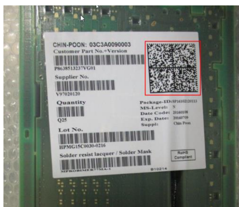
Figura 22 - Etiqueta de identificação de um PCB com Matlabel
