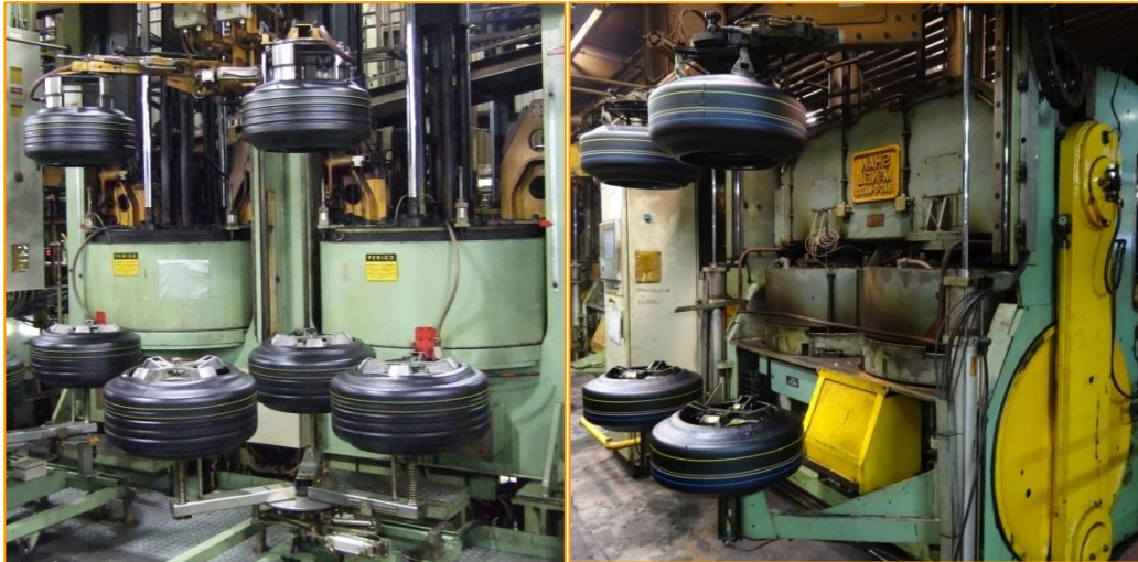
Figura 21-Prensas Hidráulicas MHI com carregadores triplos e Prensas BOM com carregadores simples
