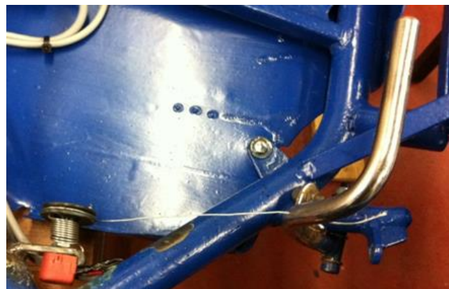
Figura 5.3 Detalhes da colocação do acelerador.
