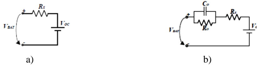
Figura 3.4 – Modelo banco de baterias implementado no Psim ; (a) modelo simplificado; (b) modelo equivalente de Thevenin .
