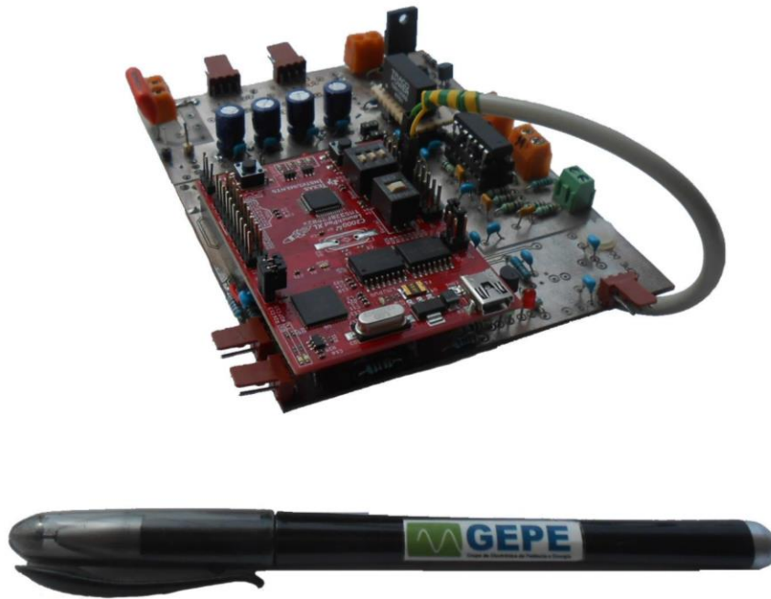
Figura 4.25 – Placa de controlo desenvolvida.
