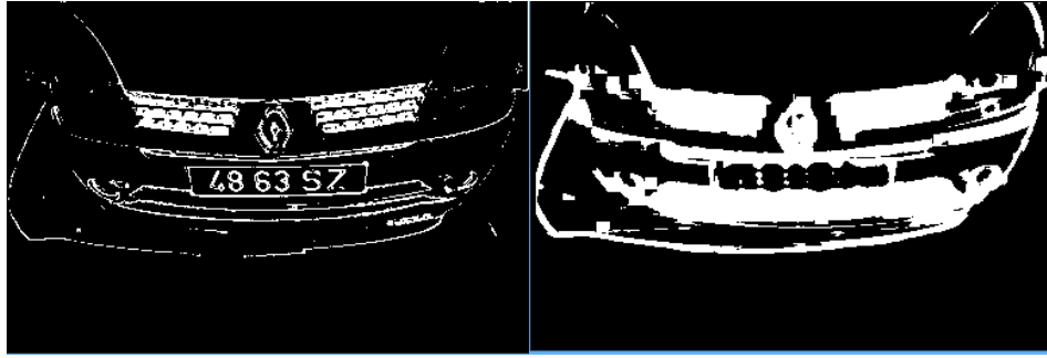
Figura 3.4.2.3 – Threshold local, utilizando o valor máximo da região no cálculo.
