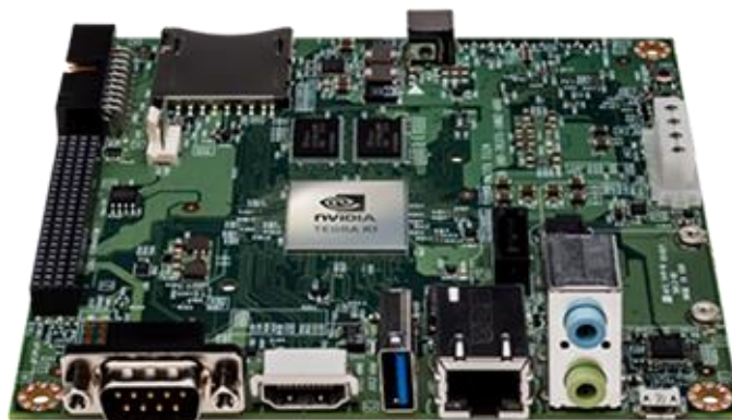
Figura 4.5.1 – Plataforma de desenvolvimento Jetson TK1
