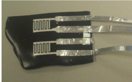
Figura 4.3 - Sensor piezoresistivo com os elétrodos colados a uma fita de alumínio através de tinta de prata condutora.
