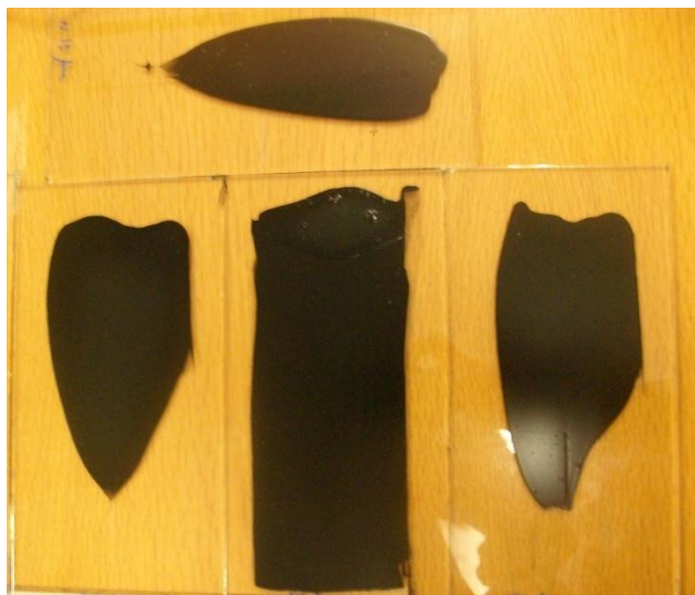
Figura 3.3 - Fase final dos compósitos CNT/SBS, espalhado na placa de vidro.
