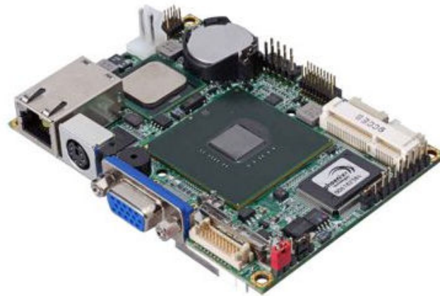
FIGURA 2.5: Sistema Embebido - Intel Atom Z510P [20]
