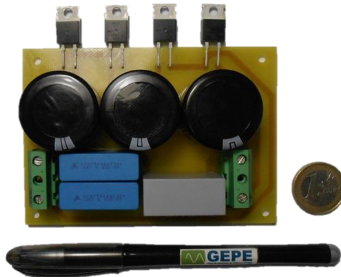
Figura 5.6 – Placa desenvolvida para a ponte retificadora de alta frequência.
