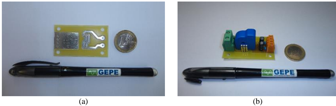
Figura 5.26 - Placa desenvolvida para os sensores de corrente: (a) vista inferior da placa; (b) vista superior já com os componentes montados.
