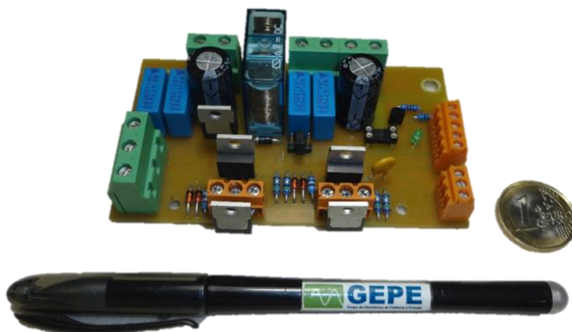
Figura 5.5 - Placa de potência desenvolvida para o lado primário do conversor CC-CC.
