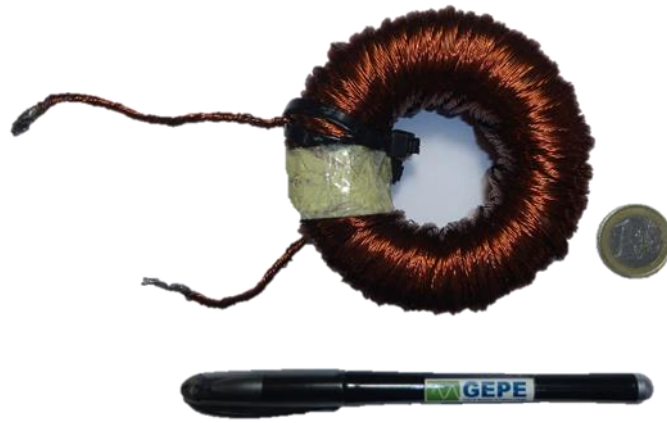
Figura 5.7 - Bobina utilizada no conversor CC-CC isolado de alta frequência.
