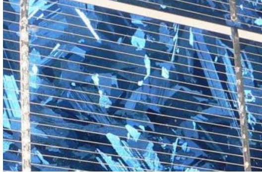
Figura 2.6 - Exemplo de uma célula solar fotovoltaica policristalina.
