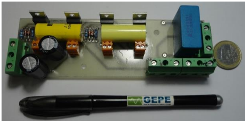
Figura 5.10 - Placa desenvolvida para o conversor CC-CA.
