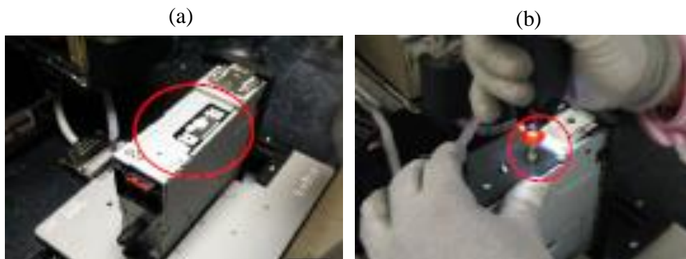
Figura 54 - Dispositivo posto 6: (a) local colocação da chapa (b) aparafusamento
