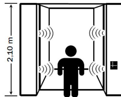
**Fig.12:** Utilização de sensores a diferentes alturas minimizando riscos
