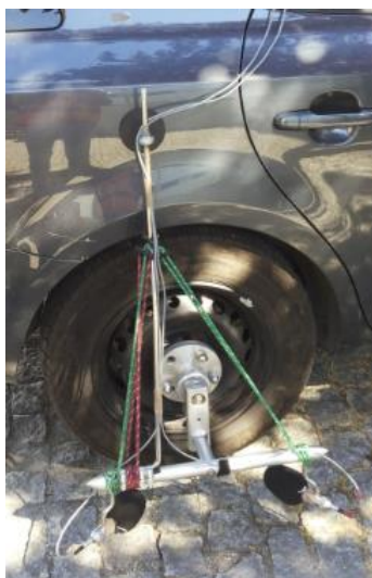
Figura 2. Método CPX montado no pneu de ensaio.
