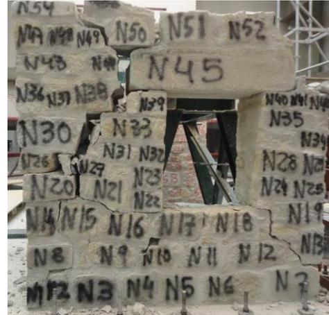
Figura 5: Modelo de pedra - evolução do dano e mecanismos formados (azul - fendas iniciais; verde - 0.66g; amarelo – 1.02g; vermelho (colapso) – 1.05g).
