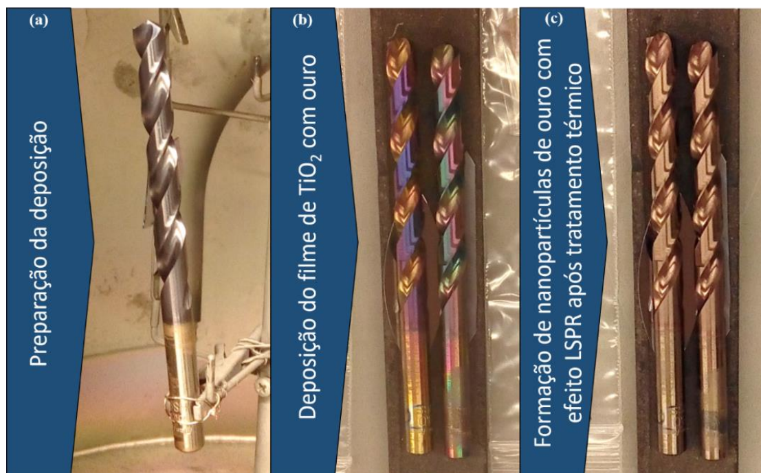
Figura 4.11 – Revestimento em 3D das brocas. Em (a) observa-se a broca na câmara antes da deposição do filme, em (b) estão as brocas com revestimentos iguais mas de espessuras diferentes e em (c) podem ver-se as mesmas duas brocas após o mesmo tratamento térmico.
