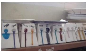
**Fig. 272.** Estudo de escorrimento de vidrados
