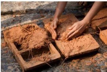
**Fig. 8.** Tijolos de argila com palha manufacturados
