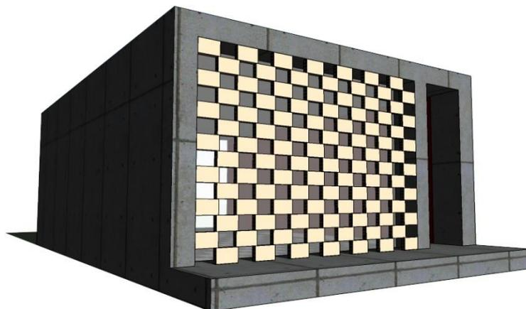
Fig. 244. Imagem virtual da célula de teste da parede 9
