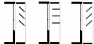
**Fig. 68.** Esquema de abertura das lâminas da fachada
