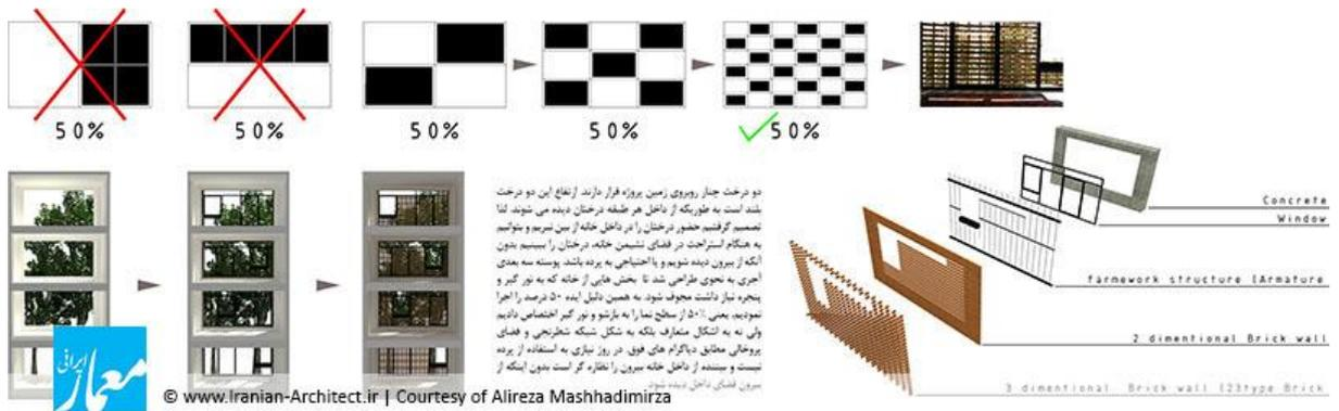
Fig. 181. Esquemas da composição da fachada por camadas
