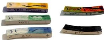
Fig. 275. Ensaio de cores de vidrados com óxidos
