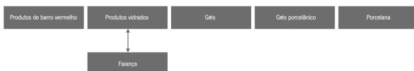
**Fig. 15.** Classificação de materiais cerâmicos segundo Bogas (2013)
