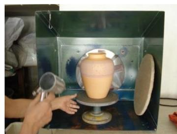
**Fig. 273.** Aplicação do vidrado por pulverização
