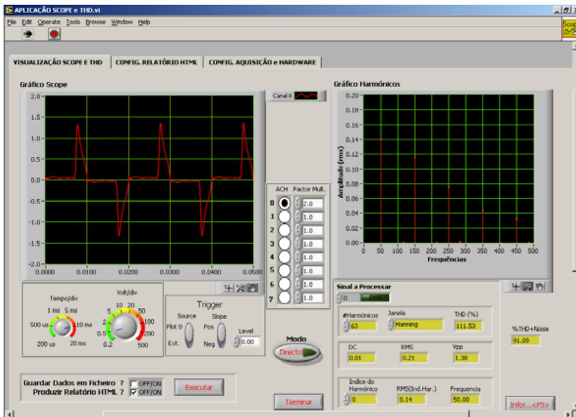
Figura 2 – Painel da aplicação *Scope* e *THD*.
