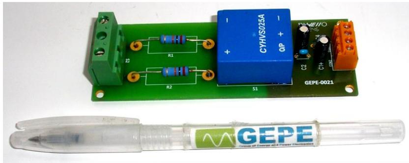
Figura 5.13 – Placa do sensor de tensão implementado para medição da tensão na rede elétrica.
