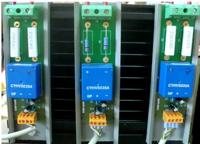
Figura 5.14 – Sensores de tensão montados na parte de trás do dissipador.
