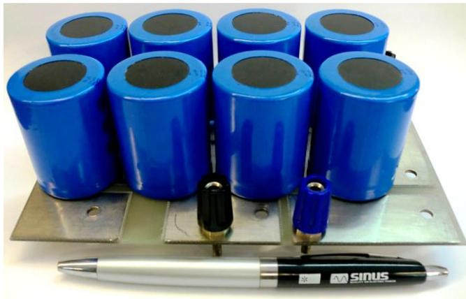
Figura 5.5 – Placa de circuito impresso com condensadores do barramento CC.
