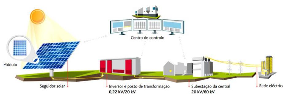
Figura 1.9 - Estrutura da central solar fotovoltaica da Amareleja [8].
