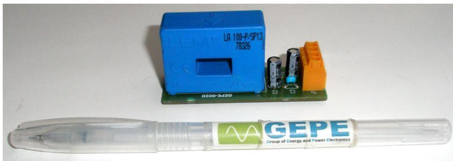
Figura 5.16 - Placa do sensor de corrente para medição da corrente injetada na rede.
