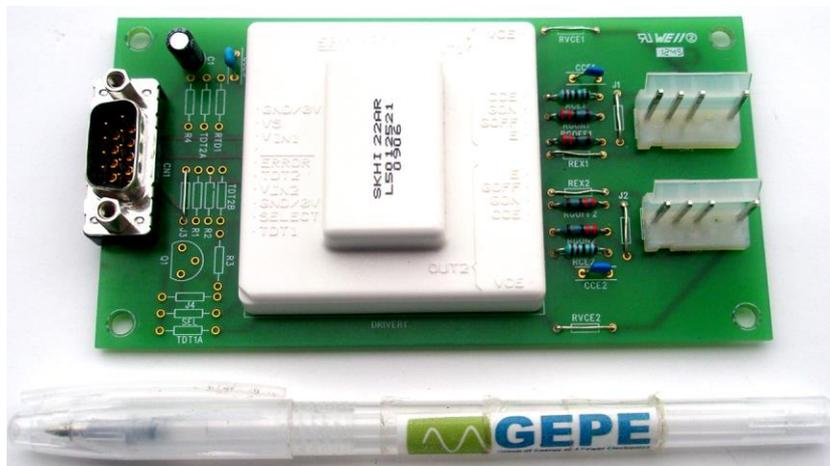
Figura 5.10 - Placa de *drive* para IGBTs [68].
