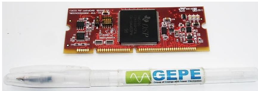
Figura 5.19- Placa de controlo *TMS320F28335*.
