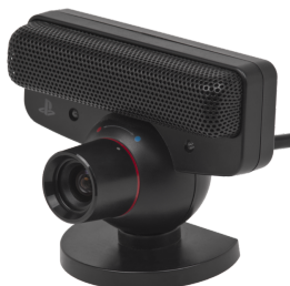
Figura 2.5: Câmara usada no reconhecimento de expressões faciais (imagem retirada de http://en.wikipedia.org/wiki/PlayStation_Eye [acedido em 2014-09-16]).
