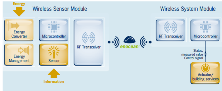
Figura 2.3: Implementação Enocean : sensor e controlador [6]
