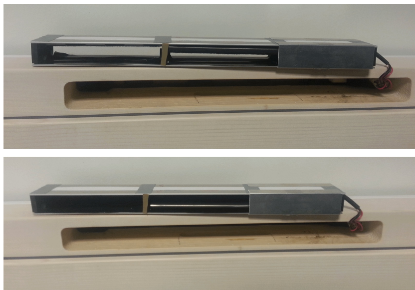
Figura 6.10: Demonstração das duas diferentes caixas das válvulas. Primeira foto com as duas abas abertas e segunda foto com as duas abas fechadas.
