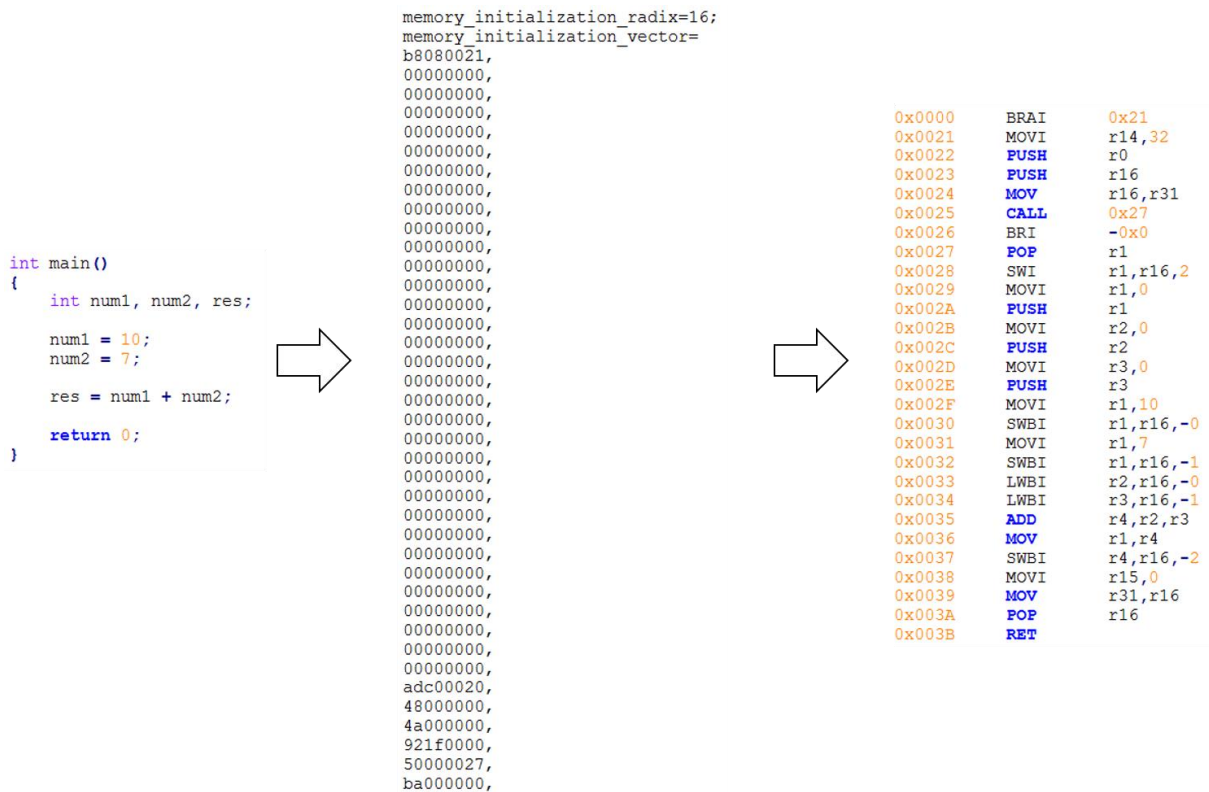
Figura 5.1 – Processo de obtenção do código assembly a partir do código C
