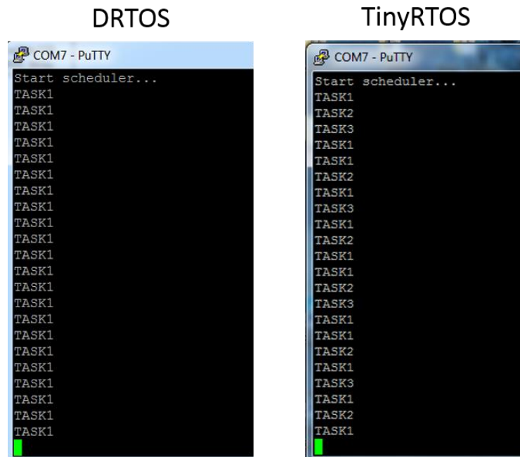
Figura 5.17 - Resultado dos dois sistemas operativos a executar a mesma aplicação
