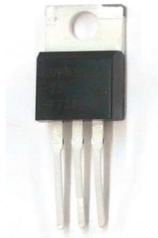
Figura 5.19 – MOSFET Vishay ( SUP85N15-21 ) usado no inversor.
