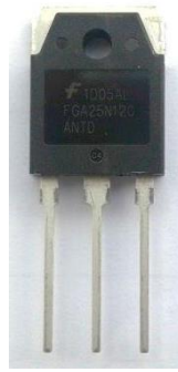
Figura 5.11 – IGBT Fairchild (FGA120ANTD25N) usado no conversor CC/CC ponte completa do tipo buck .
