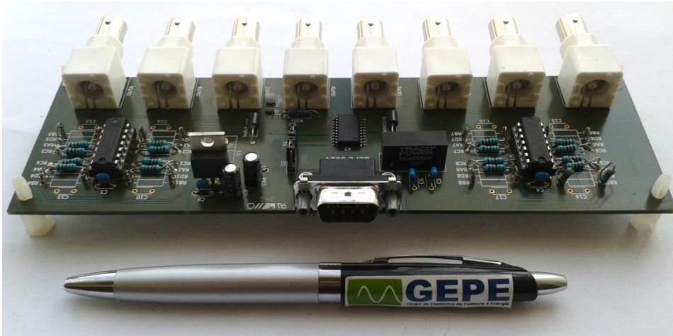
Figura 5.30 – Placa DAC utilizada no protótipo desenvolvido.
