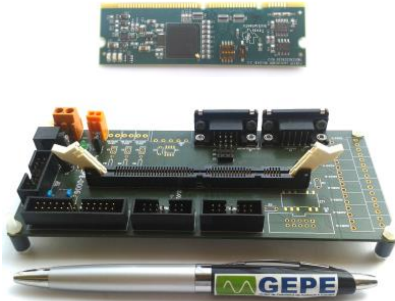
Figura 5.27 – DSP da Texas Instruments ( TMS320F28335 ) e a placa do DSP utilizados no protótipo desenvolvido.
