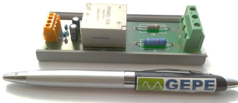
Figura 5.24 – Placa do sensor de tensão utilizada no protótipo desenvolvido.
