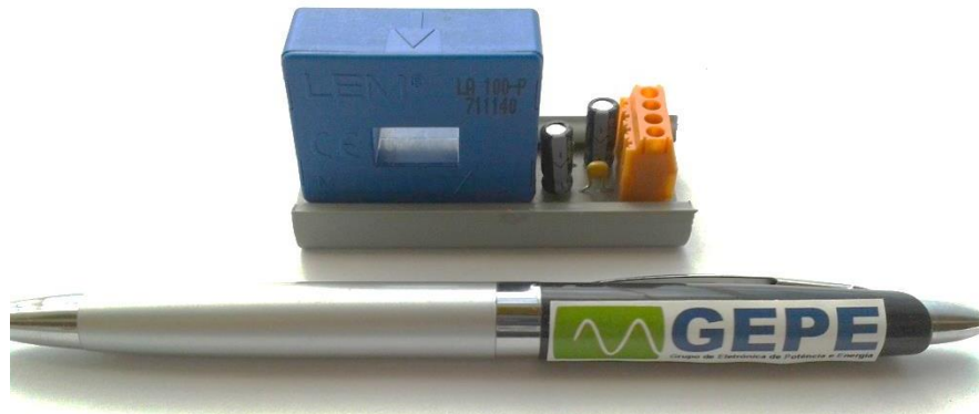
Figura 5.26 – Placa do sensor de corrente utilizada no protótipo desenvolvido.
