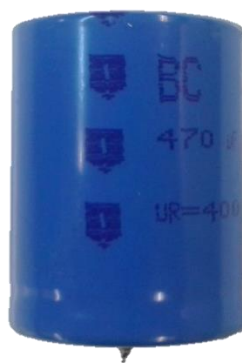
Figura 5.8 – Condensador Vishay ( MAL205756471E3 ) usado no filtro capacitivo do protótipo desenvolvido.
