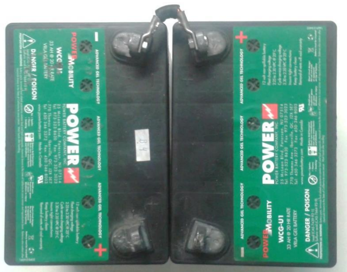
Figura 5.17 – Baterias de ácido chumbo Power Mobility (WCG-UI – Power) usadas como elemento armazenador no protótipo desenvolvido.
