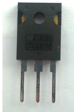
Figura 5.13 – Díodos STMicroelectronics (STTH100W06CW) usados no Conversor CC/CC ponte completa do tipo buck .
