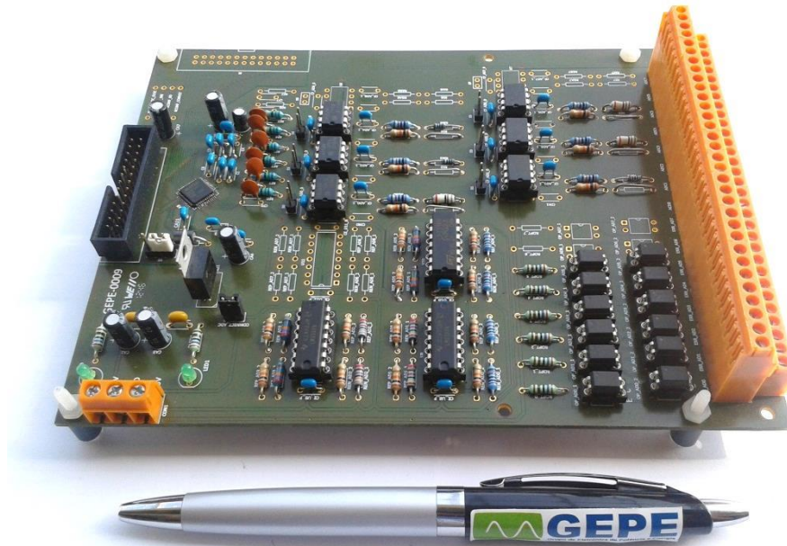
Figura 5.29 – Placa de condicionamento de sinal utilizada no protótipo desenvolvido.
