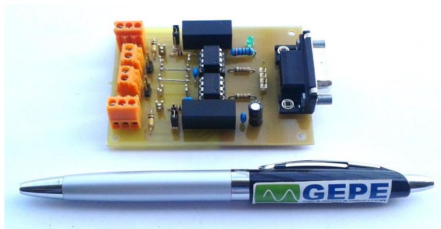
Figura 5.32 – Placa de driver dos semicondutores usada no protótipo desenvolvido.
