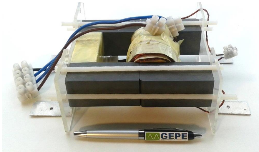
Figura 5.15 – Transformador de alta frequência do conversor CC/CC do tipo buck .
