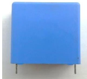
Figura 5.12 – Condensador Vishay (378 MKP) utilizado no circuito de snubber .
