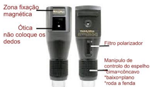
Figura 6: Componentes principais de um retinoscópio.
