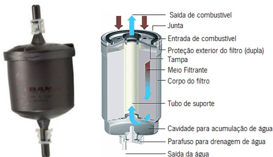
Figura 32: Filtro de combustível de um automóvel
