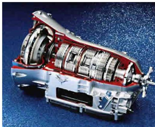
*Figura 23: Vista em corte de uma caixa de velocidades automática*
