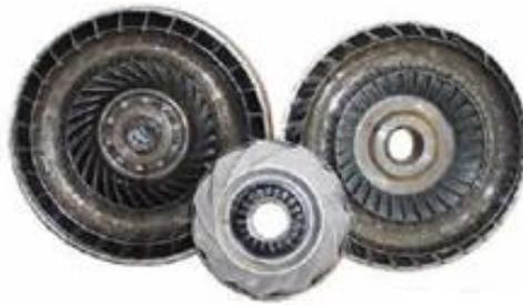
*Figura 24: Turbina, estator e bomba de uma caixa de velocidades automática
