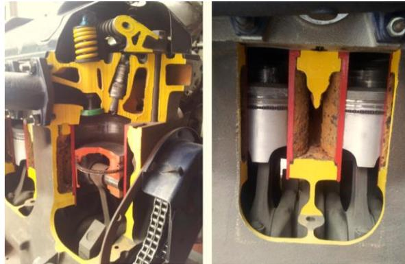
Figura 29: Vista em corte de um motor, onde se podem ver as câmaras por onde o líquido refrigerante passa
