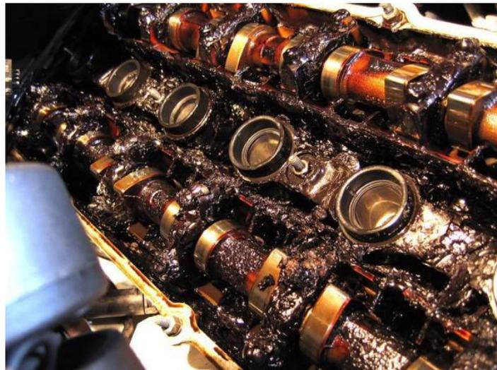
*Figura 8: Desgaste da colação do motor, devido à má escolha do óleo
