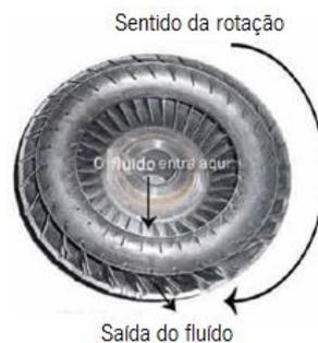
*Figura 25: Funcionamento da bomba de uma caixa de velocidades automática
