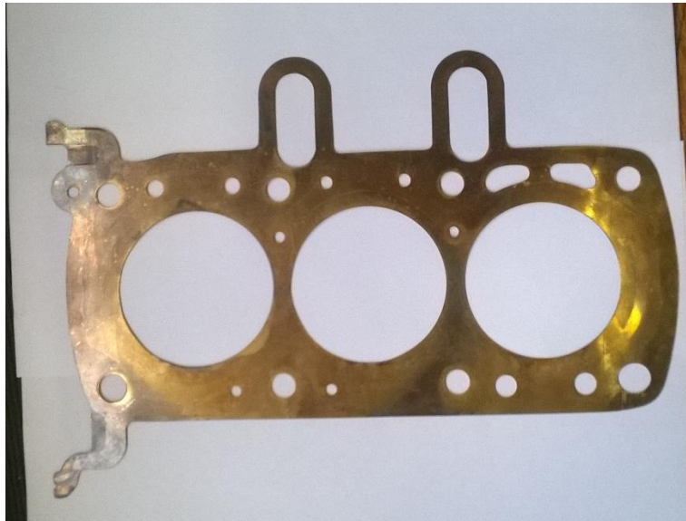
Figura 107 - Junta da culassa de 0,5 mm após o tratamento térmico
