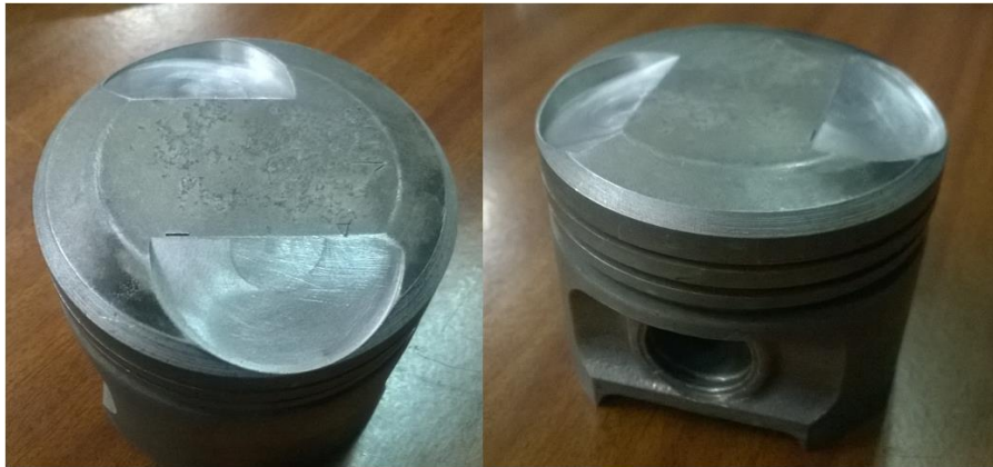
Figura 134 - Pistão final após todos os processos de maquinagem
