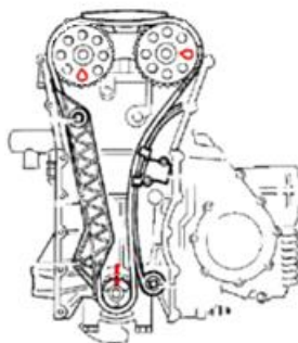
Figura 137 - Ponto do motor com árvore de cames Dwell 50 e Dwell 60
