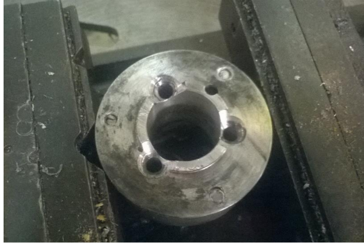
Figura 188 - Peça de ligação da roda dentada à cambota danificada
