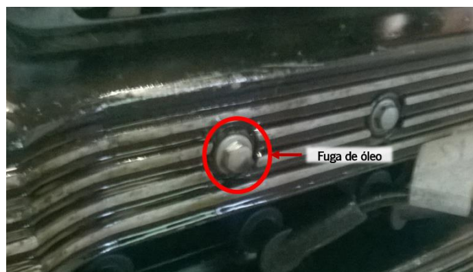
Figura 98 - Fuga de óleo na cabeça do motor
