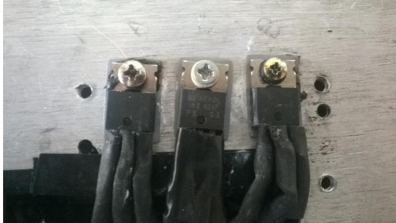
Figura 90 - IGBT após teste de funcionamento e de continuidade com a massa
