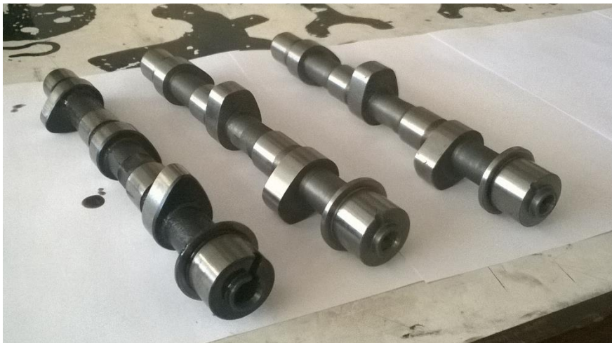
Figura 132 - Árvores de cames utilizadas para o projeto: original (à esquerda); Dwell 50 (ao centro); Dwell 60 (à direita)
