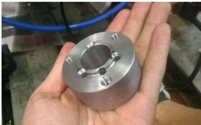
Figura 189 - Nova peça de ligação da cambota com a roda dentada
