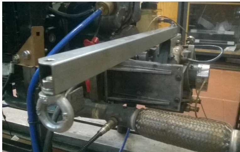
Figura 73 - Freio hidráulico com a respetiva barra de calibração
