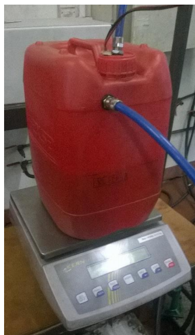
Figura 47 - Depósito de gasolina colocado sobre a balança
