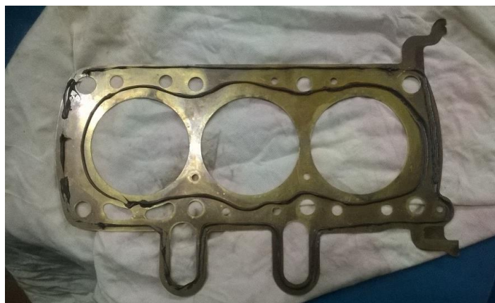
Figura 109 - Colocação da junta de cola na junta da culassa de 0,5 mm
