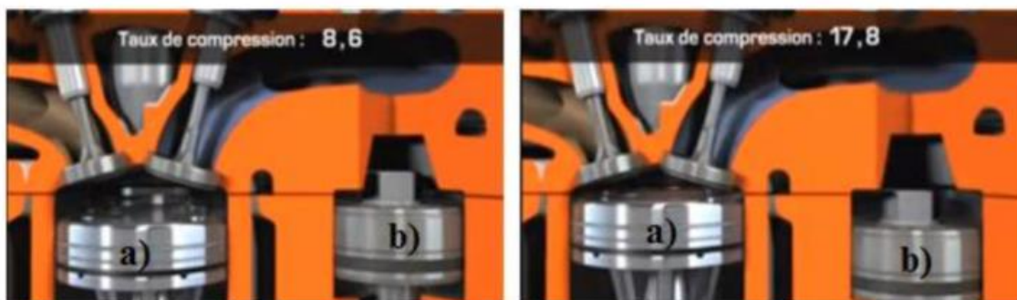
Figura 23 - Motor MCE-5 (adaptado de [4])
