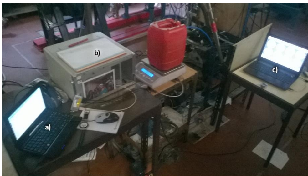
a) Leitura e registo dados da balança e da célula de carga; b) Sistema de aquisição de dados da célula de carga; c) Controlo do motor através do programa TunerStudio.
