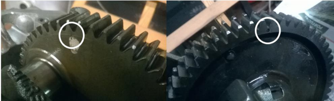
Figura 138 - Ponto de sincronismo na cambota e no eixo de transmissão (da esquerda para a direita, respetivamente)
