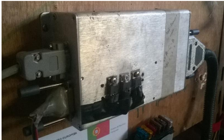
Figura 61 - Unidade de controlo utilizada - MegaSquirt II V3.0
