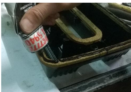
Figura 139 - Colocação de vedante numa junta
