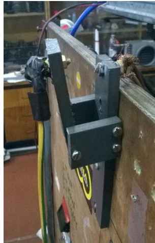
Figura 49 - Relé manual do motor de arranque
