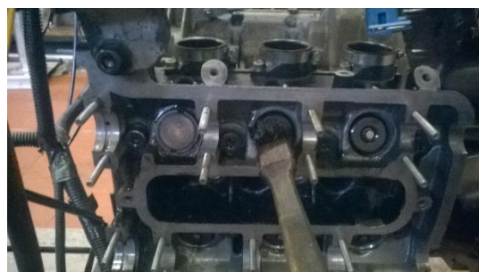
Figura 140 - Lubrificação de uma válvula de admissão
