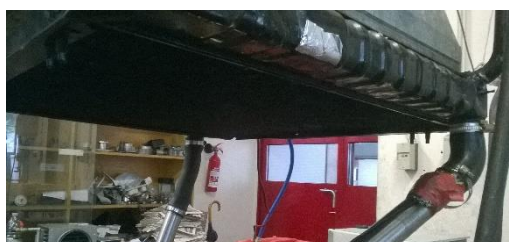
Figura 55 - Permutador de calor do líquido de arrefecimento
