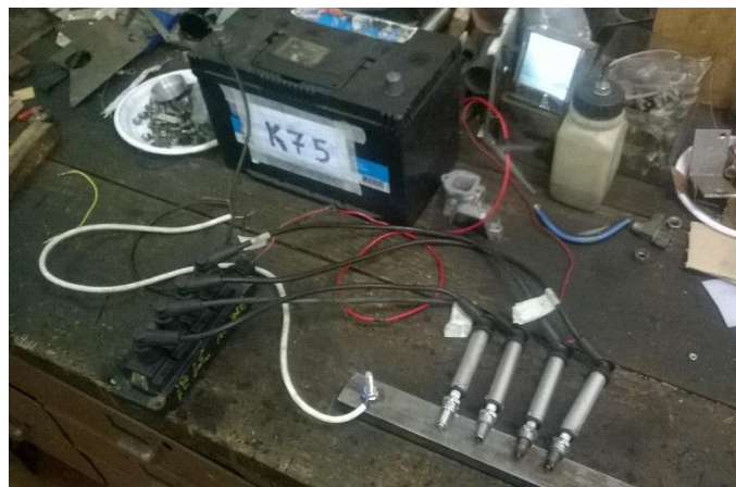
Figura 95 - Instalação experimental para determinar os pinos representativos de cada bobine
