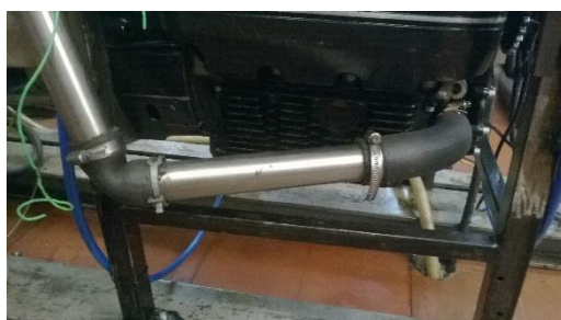
Figura 53 - Tubo de entrada do líquido de arrefecimento no motor pela bomba de água
