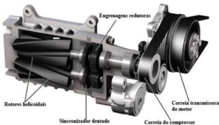
Figura 176 - Compressor do tipo parafuso (adaptado de [4])
