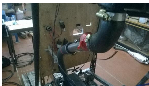
Figura 54 - Tubo de saída do líquido de arrefecimento do motor para o permutador
