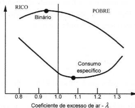
Figura 7 - Variação do consumo específico e do binário com o coeficiente de excesso de ar (adaptado de [3])
