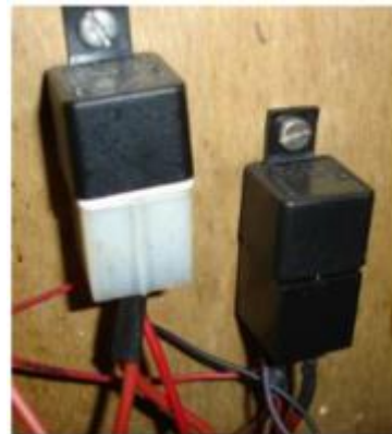
Figura 51 - Relé principal (à esquerda) e relé da bomba de combustível, ignição e controlador da sonda Lambda (à direita)
