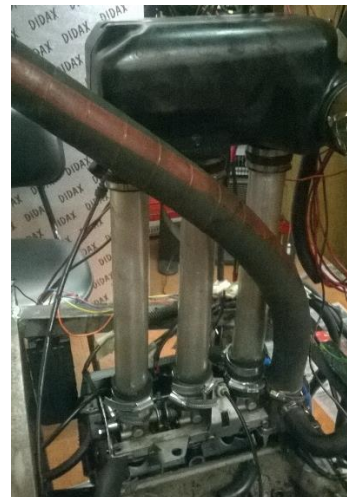
Figura 142 - Tubos instalados no sistema de admissão do motor BMW K75
