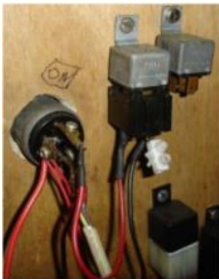
Figura 50 - Canhão de ignição e relé original do motor de arranque visto por trás
