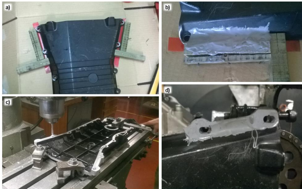
Figura 101 - a) Preparação do molde para adicionar a epóxi b) Enchimento dos moldes com epóxi c) Fresagem da epóxi d) Produto final
