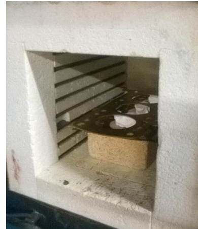
Figura 106 - Juntas da culassa no forno, preparadas para o tratamento térmico
