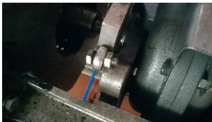
Figura 192 - Parafuso da célula de carga fraturado
