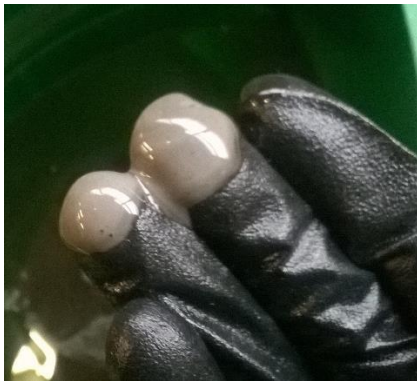
Figura 103 - Óleo retirado após o problema da junta da culassa
