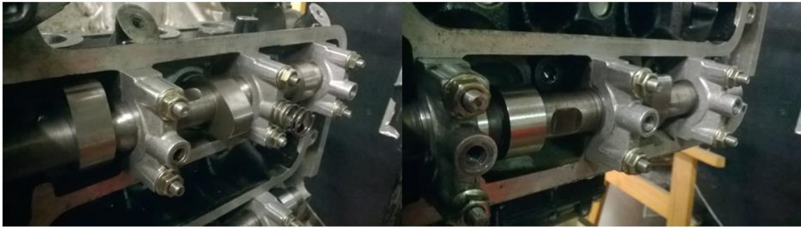
Figura 133 - Árvore de cames Dwell 50 e árvore de cames de espace projetada instaladas na culassa (da esquerda para a direita, respetivamente)
