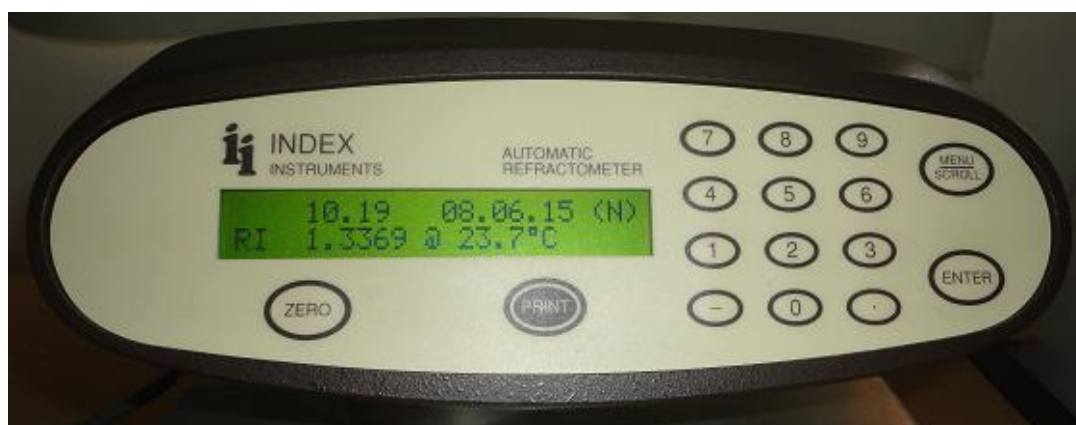
Figura 3.9. Exemplificação dos dados recolhidos para o índice de refração no display do equipamento
