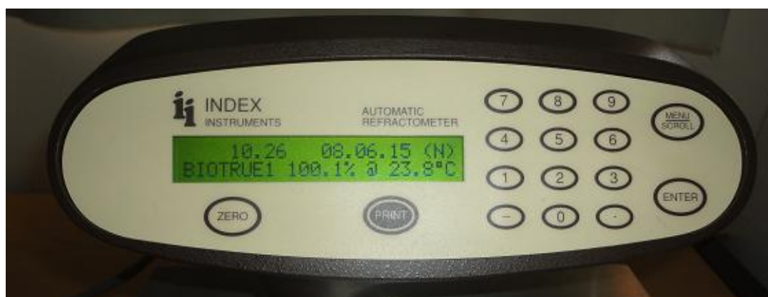
Figura 3.8. Exemplificação dos dados recolhidos para a percentagem de água no display do equipamento
