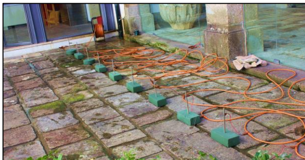
Figura 33 – Pormenor da utilização de espumas fenólicas na aquisição de dados na área C.
