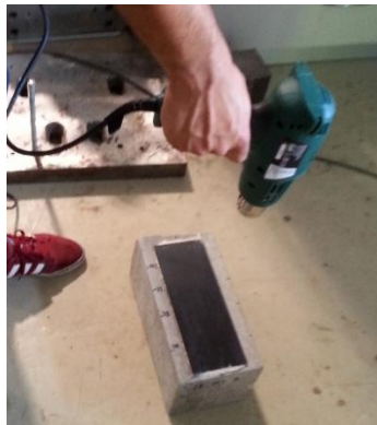
Figura 6.5: Aplicação de energia térmica ao provete.
