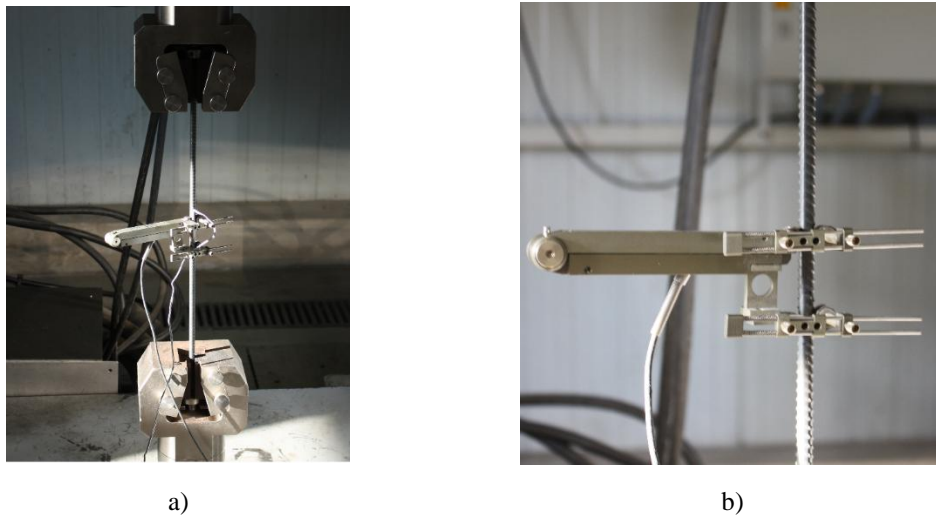
Figura 3.6: a)Aspeto geral dos ensaios de caracterização do aço; b) e pormenor do ensaio de tração
