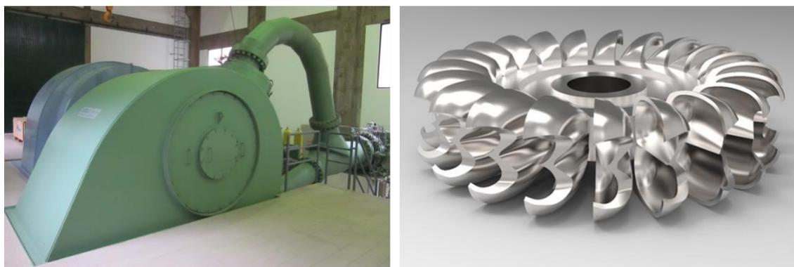
**Figura 32** – Turbina *Pelton*.
