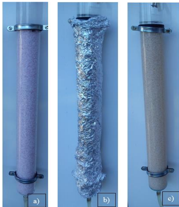
Figura 16 Colunas reativas antes (a), durante (b) e após (c) o ensaio de adsorção.
