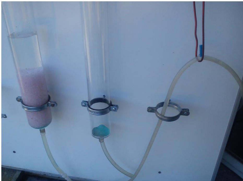
Figura 15 Avaliação das perdas de carga iniciais na camada filtrante G2, para diferentes caudais.
