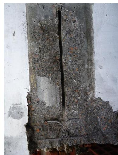
Figura 5.10 - Aspeto final do provete PO\_BL30\_D6\_1, após realização de ensaio
