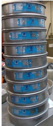
Figura 3.2 - Peneiros utilizados para a peneiração dos agregados
