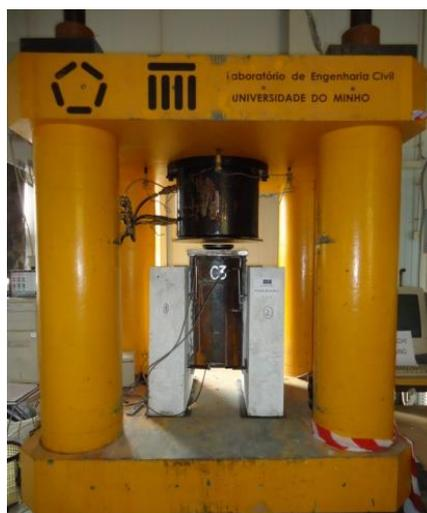
Figura 5.1 - Pórtico utilizado para o ensaio do tipo *Push-out*
