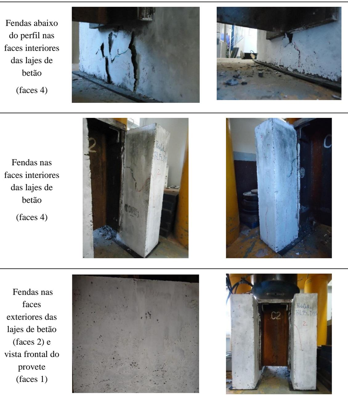
Figura 5.8 - Evolução da fendilhação nas lajes do provete PO\_BL15\_D10\_1
