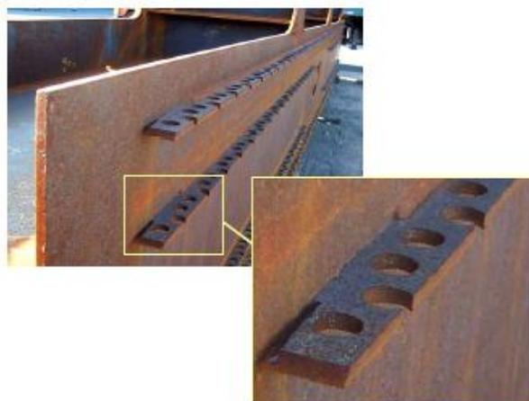
Figura 2.8 - Conector tipo Perfobond
