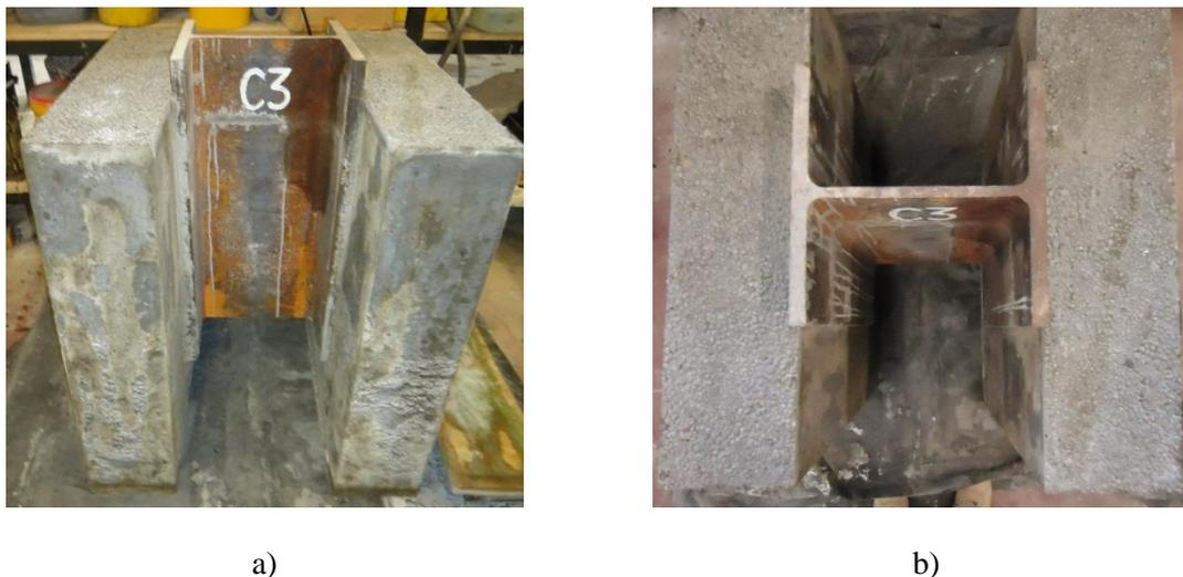
Figura 4.8 - Provetes descofrados
