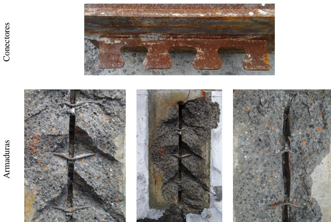
Figura 5.7 - Aspeto final do provete PO\_BL15\_D6\_1, após realização de ensaio
