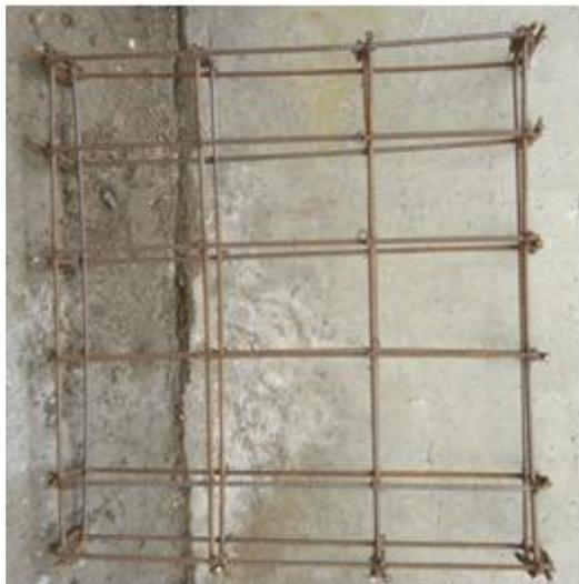
a) Armadura com 6 mm de diâmetro
