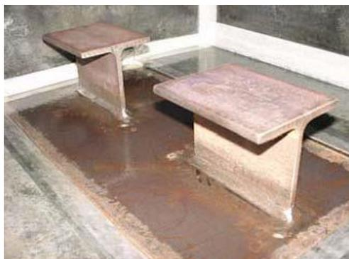
Figura 2.6 - Exemplo de um conector T
