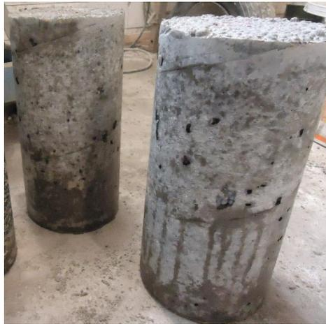
Figura 3.7 - Cilindros utilizados para a determinação das características do betão leve
