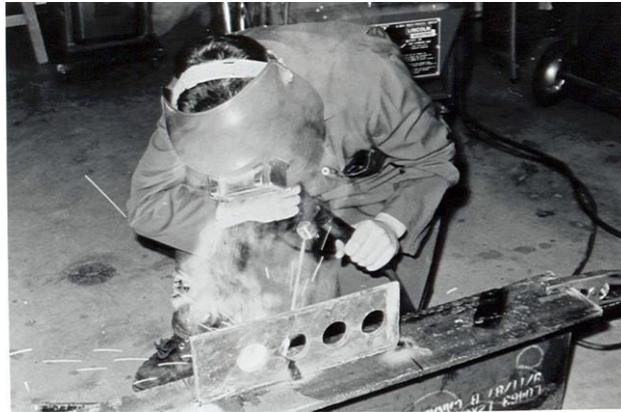
Figura 2.7 - Conector *Perfobond* sendo soldado á mesa de uma viga (Ogueijofor, 1994)
