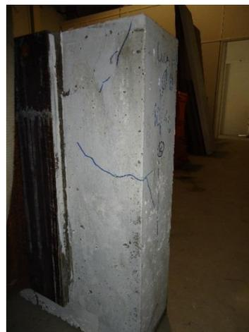
Figura 5.13 - Evolução da fendilhação nas lajes do provete PO\_BL30\_D10\_1
