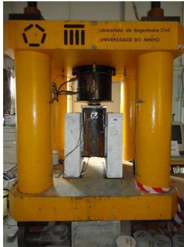
Figura 2.14 - Equipamento disponível para o ensaio de tipo *Push-out*
