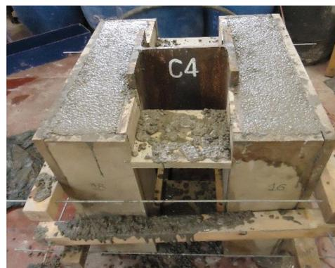
b) Cilindros e provete betonados
