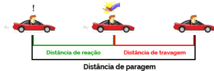
Figura 8 - Distâncias de reação, de travagem e de paragem ( http:// www.obomcondutor.pt )
