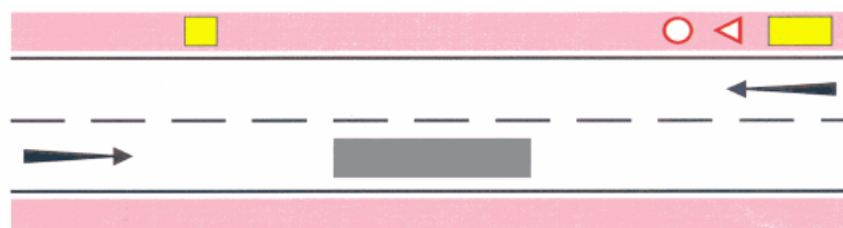
Figura 22 – Fase um da colocação da sinalização temporária (Estradas 1997)
