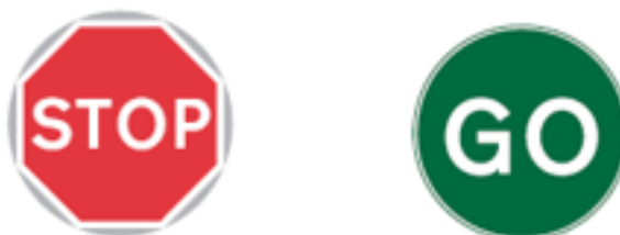
Figura 56 – Raquetes utilizadas no sistema stop/go (Government 2009)
