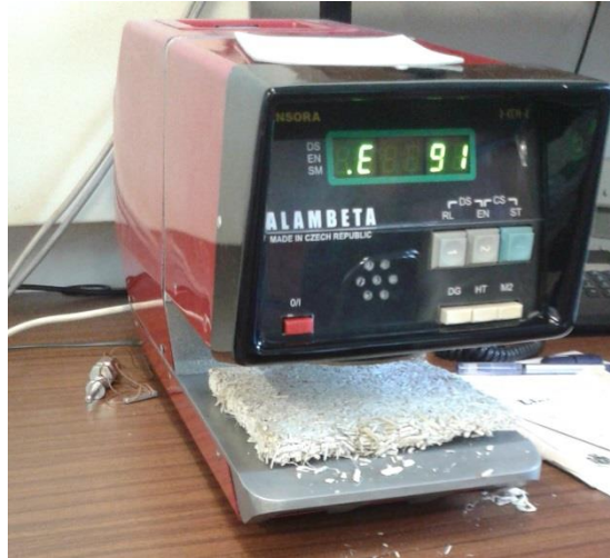
Fig. 35 - Ensaio da condutividade térmica
