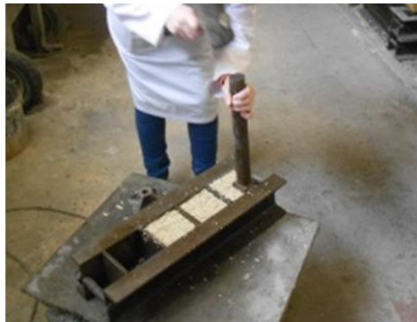
Fig. 27 - Processo de produção da mistura
