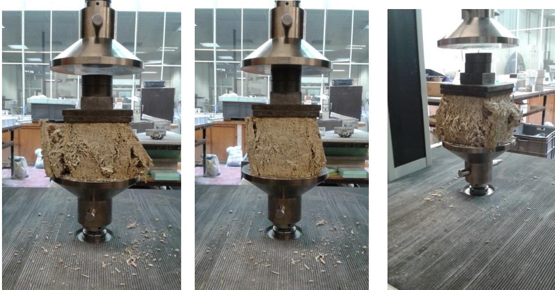
Fig. 33 - Ensaios de resistência à compressão - roturas
