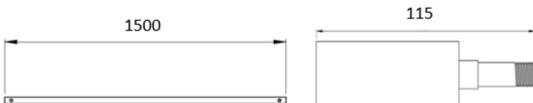
Figura 4.69 Varão do polímero e suporte das roldanas diretoras
