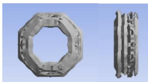
Figura 38 – Vista de cima e lateral respectivamente do tubo deformado
