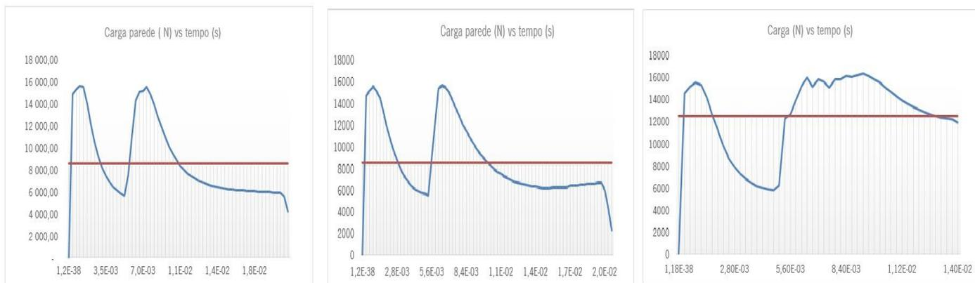
Figura 41 – Comparação gráficos carga vs tempo do trigger a 5 mm , a meio e no último terço do tubo respetivamente
