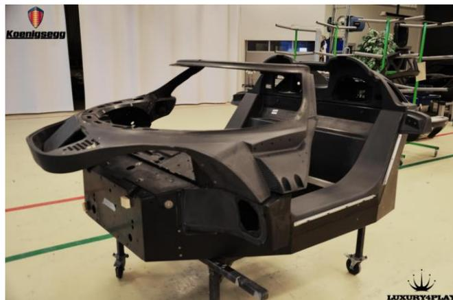
Figura 6 – Chassis monocoque em fibra de carbono [16]
