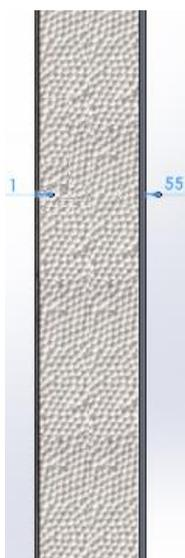
**Figura 5-18 - vista em corte do painel 15: Aço inox; Poliestireno; Aço inox**
