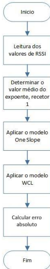
Figura 3.22 - Fluxograma de tratamento de dados MatLab, ambiente interno.
